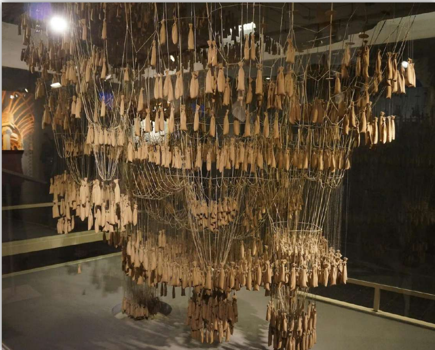
Modello utilizzato da Gaudí per sperimentare la struttura della 'Sagrada Família'
